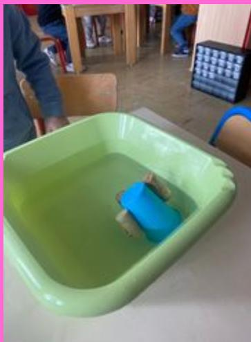
Essai 1 : un gobelet et des bouchons collés sur les côtés verticalement. Il flotte mais chavire, on doit le stabiliser
