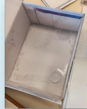
Boîte en carton (le glaçon est encore conservé il est aussi gros ou plus gros que le glaçon témoin)
