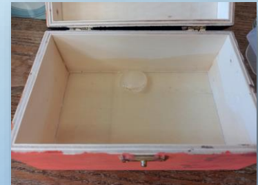
Boîte en bois (le glaçon est encore conservé il est aussi gros ou plus gros que le glaçon témoin)
